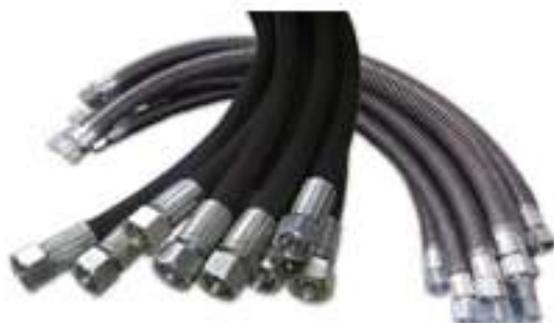
Рукава РВД ТУ 4833-003-63588945-12 – это рукава высокого давления с одной (1SN) или двумя (2SN) металлическими оплетками опрессованные фитингами на концах, предназначены для применения в качестве трубопроводов в гидравлических системах машин и механизмов различных отраслей.
